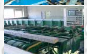
Säumerzuführung mit Laservermessung
