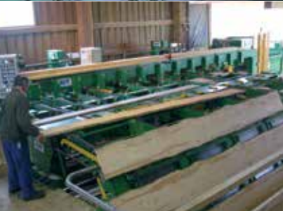
Entzerrstufe mit darauffolgender Laservermessung
