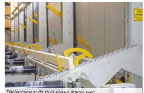
Déchargement de stockage en étagés avec amenée aux lignes d'encollage
