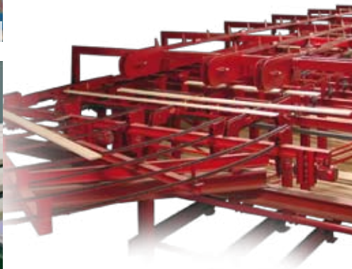
Déligneuse avec mesurage laser: ASM (4 lames mobiles)
