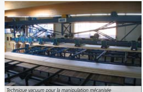
Technique vacuum pour la manipulation mécanisée de bois raboté et de bois collé
