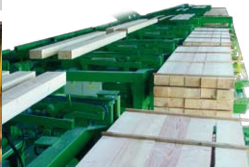
Empilage pour planches centrales et latérales
