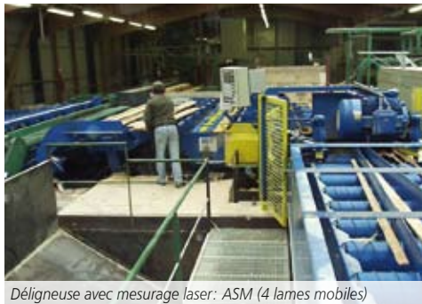
Déligneuse avec mesurage laser: ASM (4 lames mobiles)
