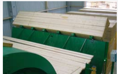
Dépilage par table basculante avec démêleur de planches
