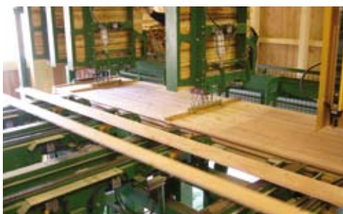
Empilage avec pose automatique des lattes
