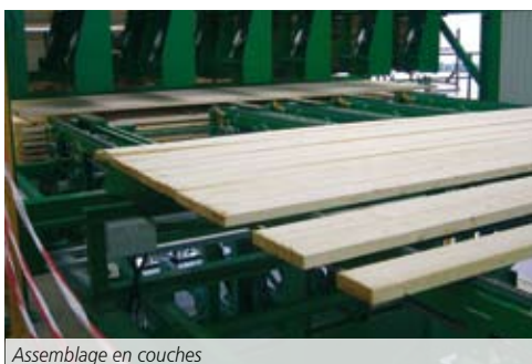
Assemblage en couches
