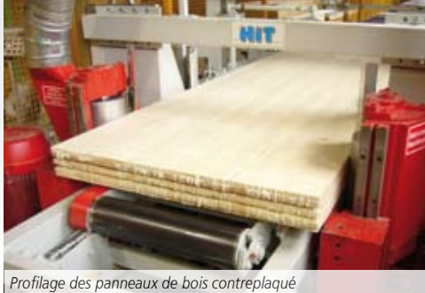
Profilage des panneaux de bois contreplaqué
