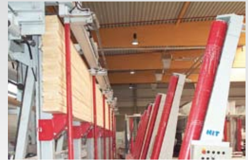
Assemblage de bois lamellé-collé avec chariot basculant
