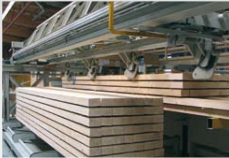
Dépilage par poussoir des lits de bois de grande longueur
