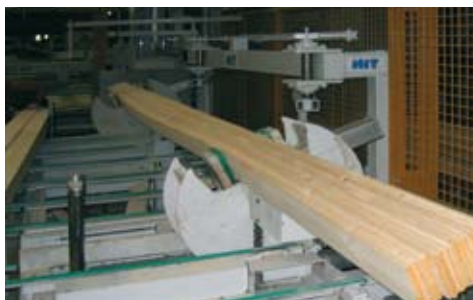
Retournement des lamelles avant encollage
