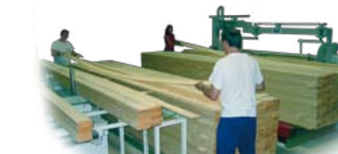
Appréciation de la qualité, empilage des lamelles par tourneur
