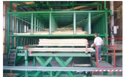
Trieuse à casiers type BSK (vue arrière) avec aide à l'empilage
