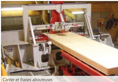
Canter et fraises abouteuses
